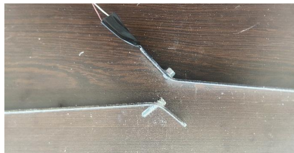
(d) T-S type failure
