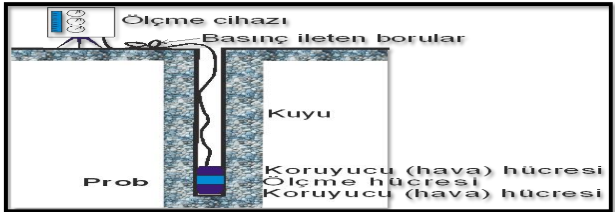
Şekil 3.5. Presiyometre deney aletinin şematik gösterimi (DSİ 2014)
