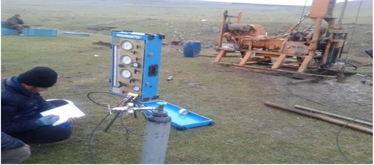
Şekil 3.6. Mollakent Göleti presiyometre deneyi çalışmaları (DSİ 2014)
