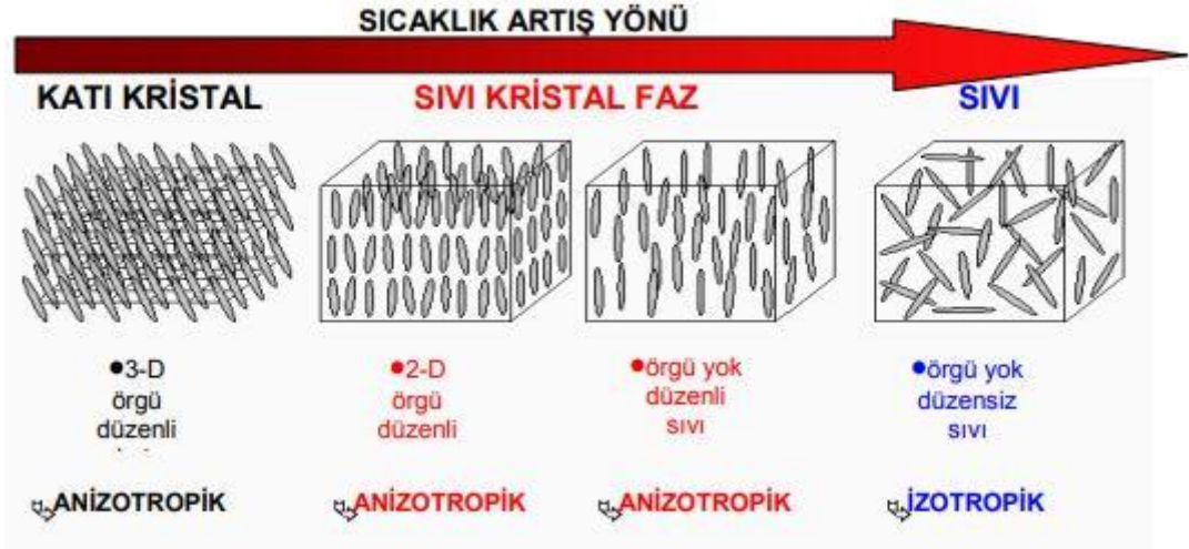
Şekil 2.2. Katı kristal ile sıvı arasındaki farklı sıvı kristallik yapılar
