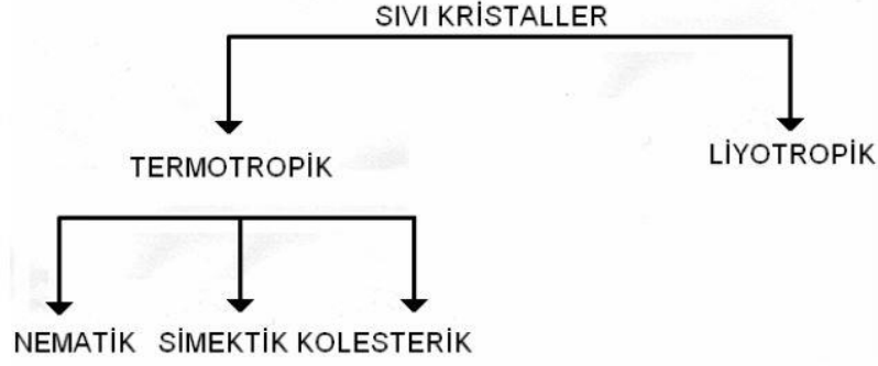
Şekil 2.3. Sıvı kristallerin genel olarak sınıflandırılması
