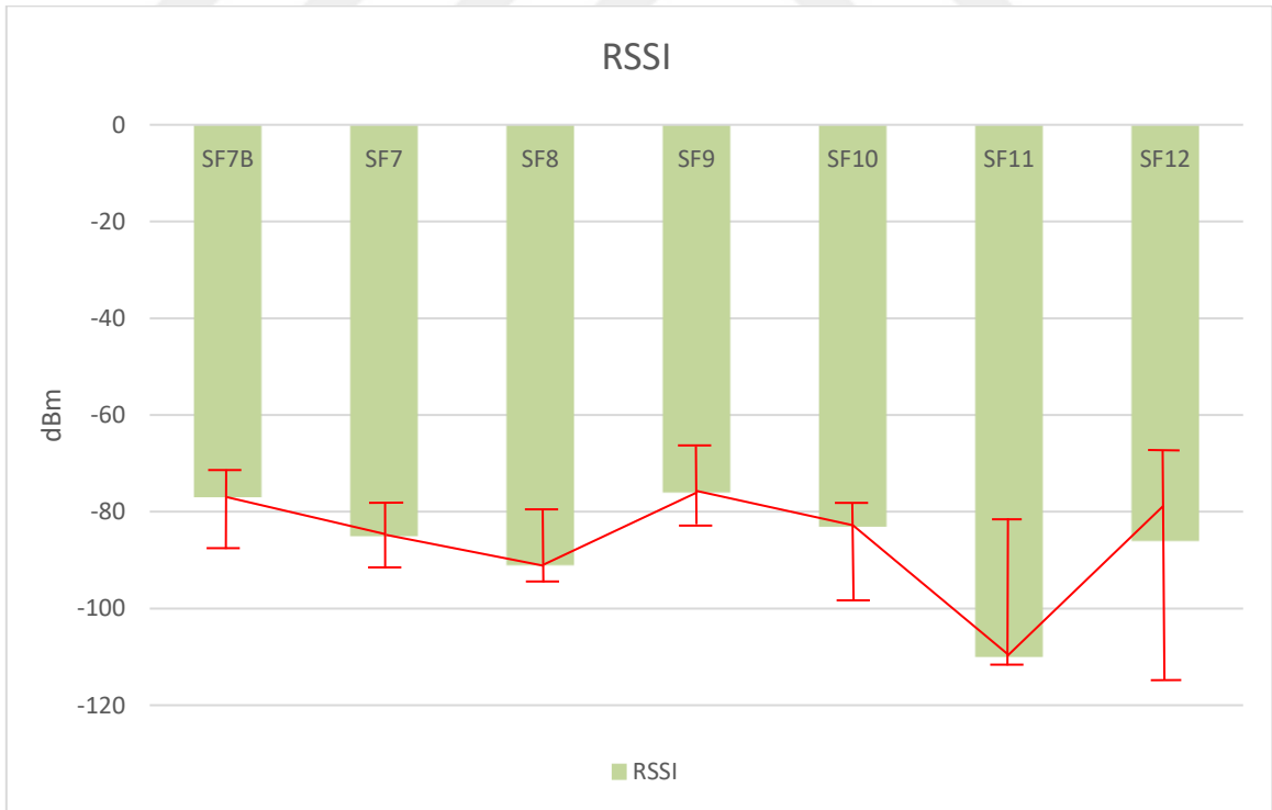
Şekil 3.16. SF Değerlerine Göre RSSI Ölçümü (251.2 m Mesafeden Test Ölçümleri)
