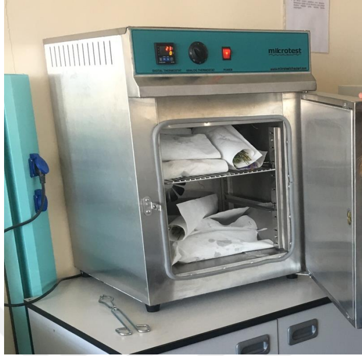
Şekil 5.12. Saf Sudan Geçirilen Örneklerin Etüvde Kurutulması
